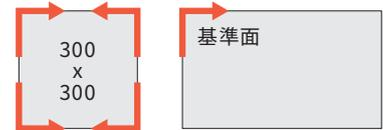
■直角度 長さLを基準とした幅Wの直角度(mm)
